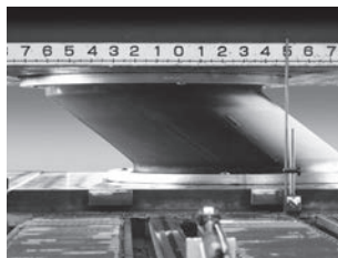
実大免震装置を用いた大変形性能試験の様子
